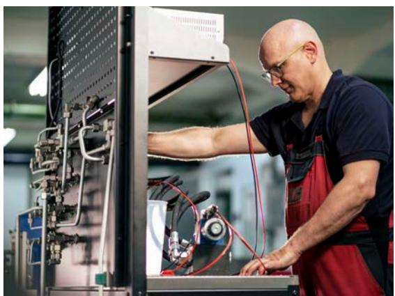
Durch modernste Messsysteme unseres Prüfstandes können wir Drehzahlen und Drehmomente mit einer Genauigkeit von 0,1% ermitteln. Die Leistungsaufnahme und -abgabe Ihrer Pumpen, Motoren, Zylinder oder Ventile werten wir elektronisch aus, jederzeit digital im Display am Steuerpult des Prüfstandes sichtbar. Die Messwerte des Prüfstandes werden automatisch an den Server übertragen und ein Prüfprotokoll erstellt.
